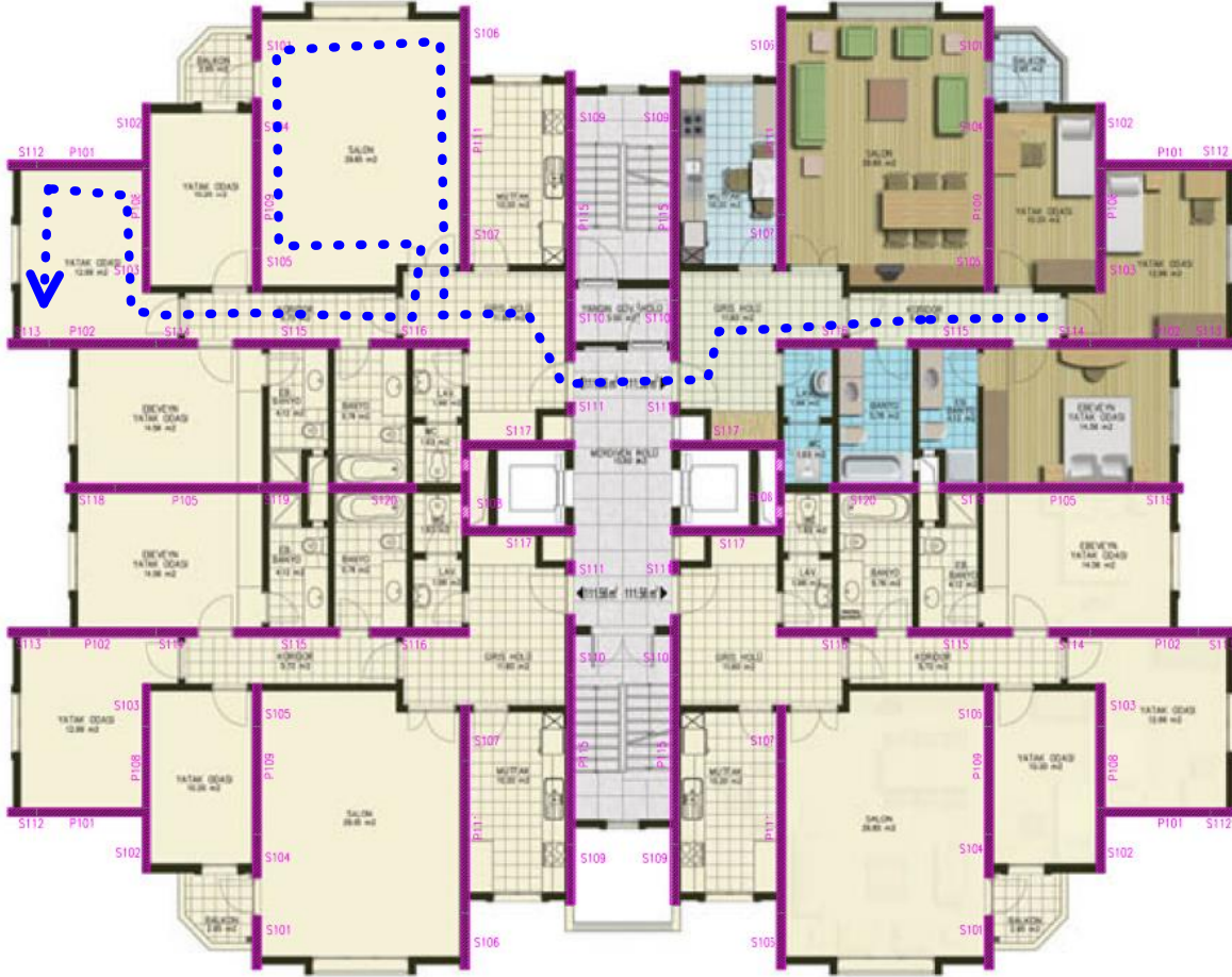
Şekil 6.14. Güneşpark B Blokları Bodrum katlarında temel derinliğini bulmaya yönelik olarak şekilde verilen 400 mHz antenle gerçekleştirilen GPR profilleri. Pembe çizgi GPR ölçüsünün alındığı profilini ve kare simgesi ise yapı radarı ile gerçekleştirilen ölçü noktalarını göstermektedir.
